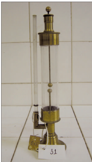
Fig. 3 - Kinnersley's thermometer, E.E. Culto à Ciência collection (photo: R. A. Meloni).
