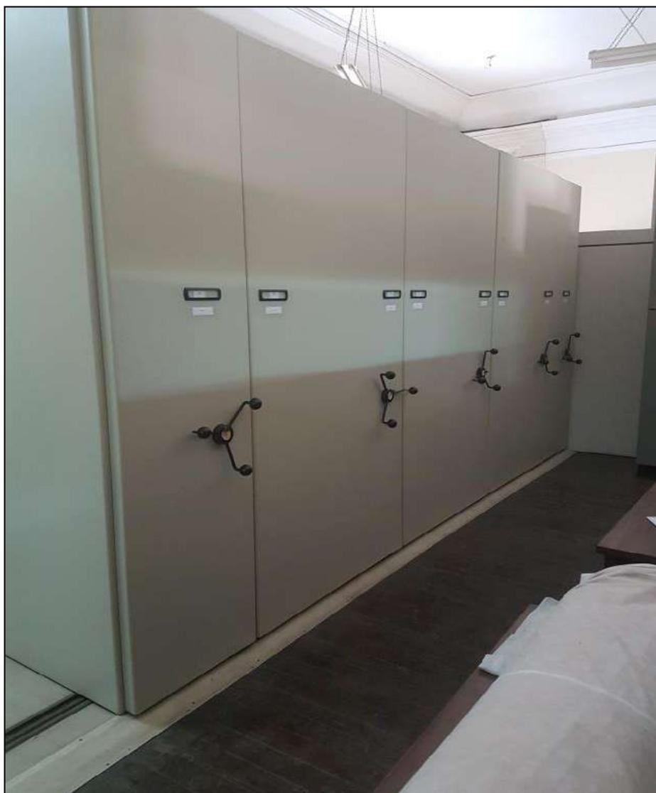
Imagem 114: Compactador deslizante no piso de madeira.
