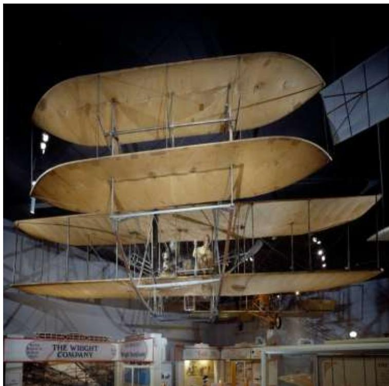
Figura 19b – Aeronave Wright Military Flyer (1909) – Estrutura de madeira e tecido, sendo o primeiro avião militar em operação.
