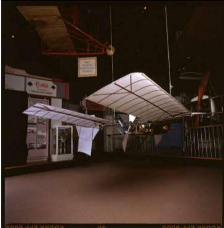
Figura 19a – Aeronave Langley Aerodrom Number 5 (1891) – Estrutura de metal e asas de madeira cobertas com tecido de seda.
