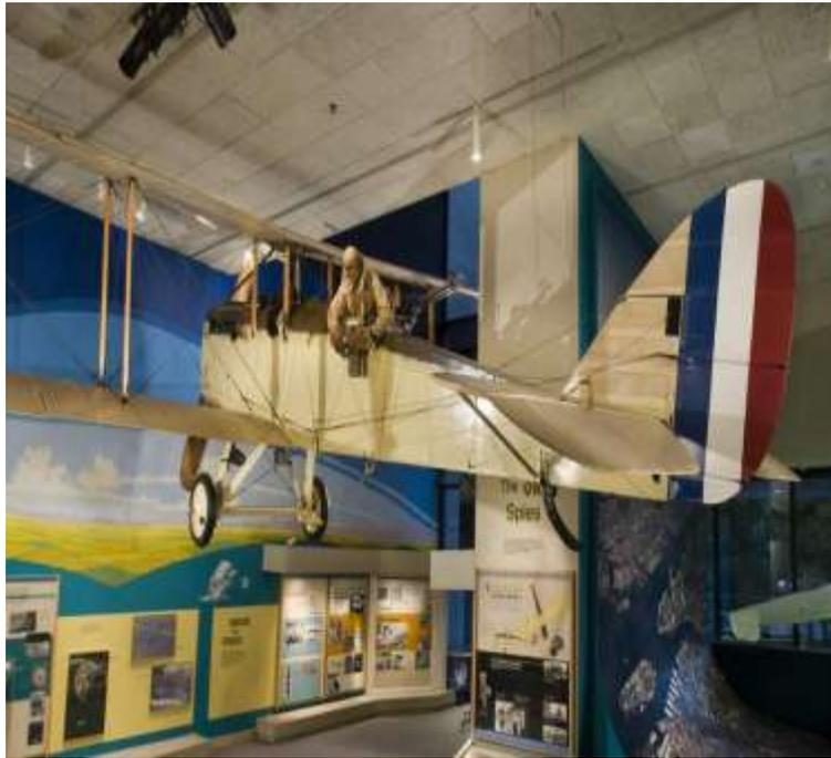
Figura 19c – Aeronave De Havilland DH-4 (1917) – Avião militar em estrutura de madeira.
