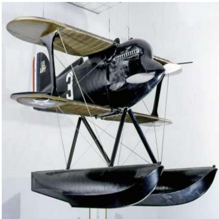
Figura 19d – Aeronave Curtiss R3C-2 – Avião militar em estrutura de metal e madeira.
