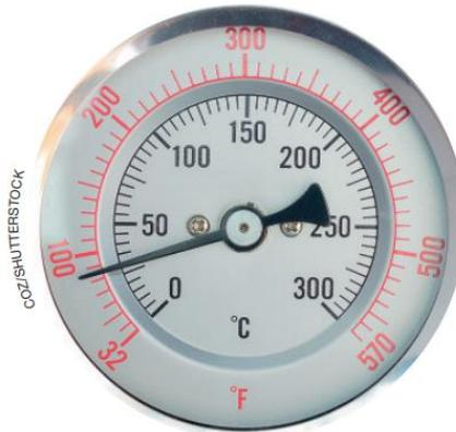
Termômetro de lâmina bimetalica, geralmente utilizado na gastronomia.
