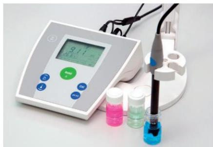
Peagômetro medindo o pH de uma solução. Esse aparelho é utilizado, por exemplo, na agricultura, no tratamento e purificação da água e nas indústrias alimentícia, farmacêutica, petroquímica e de papel e celulose.
