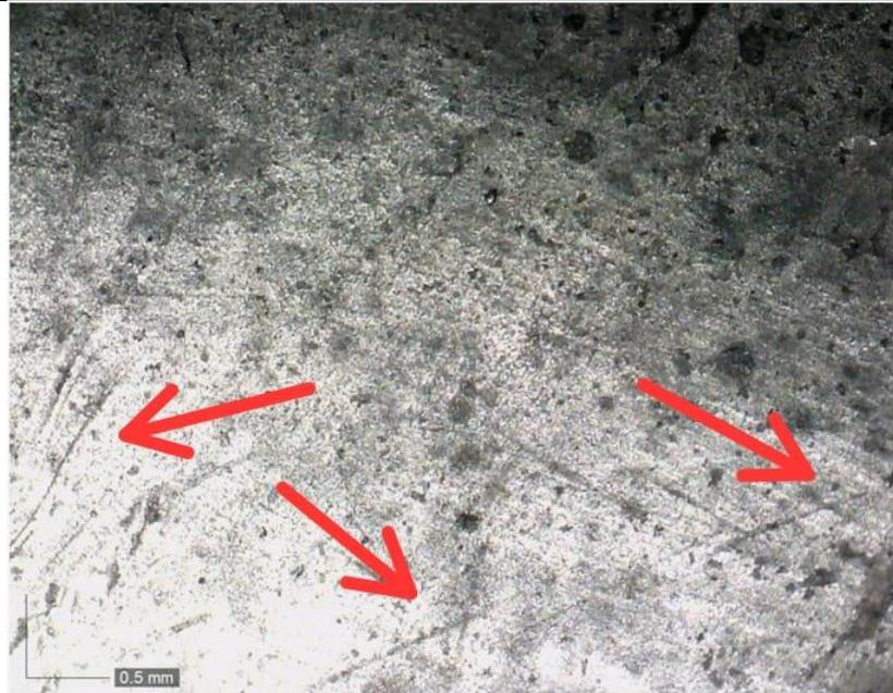
A micrografia ótica mostra região com marca de queima e fuligem (em toda a área da imagem) e marcas de fissuras e ranhuras (indicadas pelas setas vermelhas).
