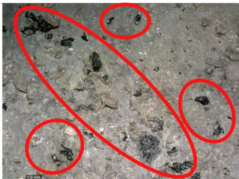
A micrografia ótica mostra região escurecida por marca de queima (em toda a área da peça) e pontos de abrasão (indicados pelas elipses vermelhas).
