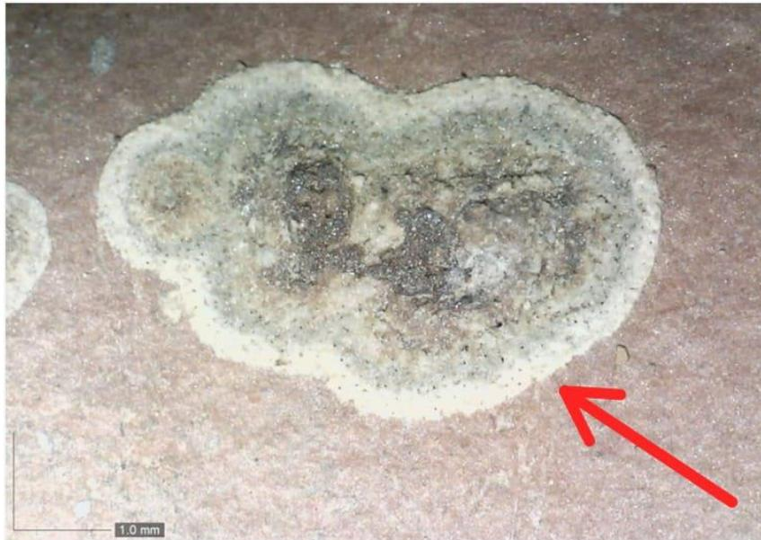
A micrografia ótica mostra presença de incrustação (indicada pela seta vermelha).
