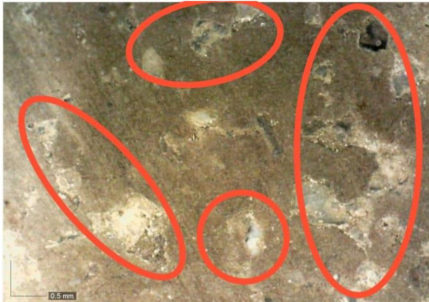
A micrografia ótica mostra região da peça com marca de queima (toda a imagem), contendo pontos de abrasão (nas diversas áreas indicadas pelas elipses vermelhas).
