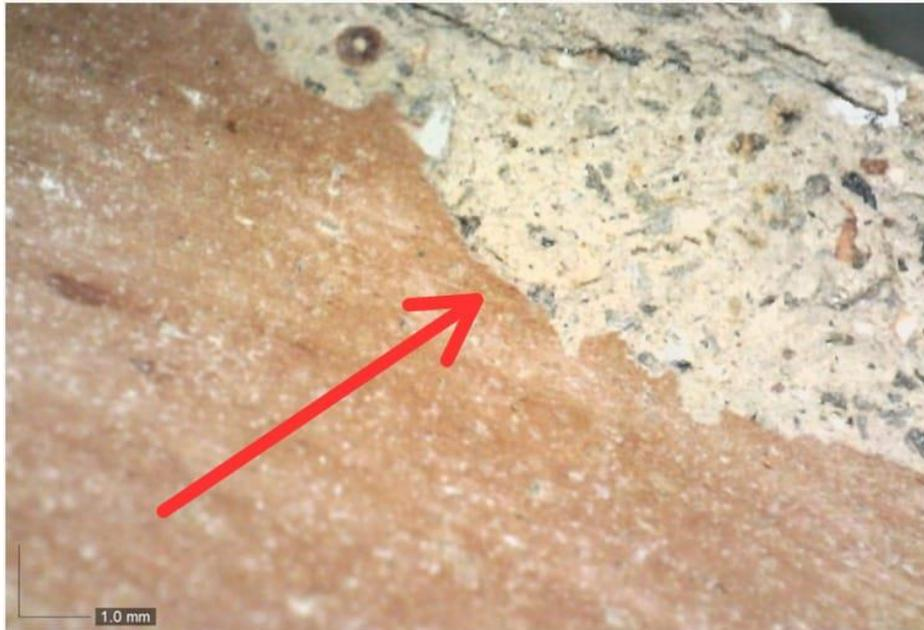
A micrografia ótica mostra local de quebra na borda da peça (indicado à direita da seta vermelha).
