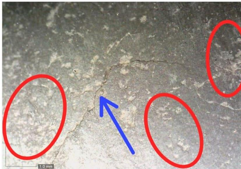
A micrografia ótica mostra região apresentando pontos de abrasão (indicados pelas elipses vermelhas) e rachadura (indicada pela seta azul).
