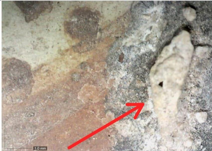
A micrografia ótica mostra região pintada com alteração da coloração original (em toda a área da imagem) e ponto de incrustação (indicado com a seta vermelha).
