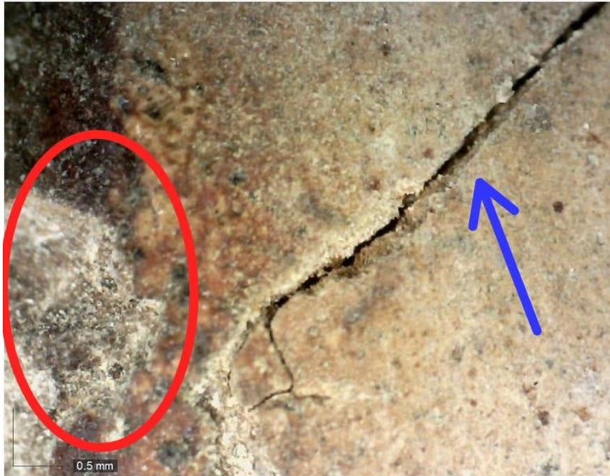
A micrografia ótica mostra região com abrasão (indicada pela elipse vermelha) e rachadura (indicada pela seta azul).
