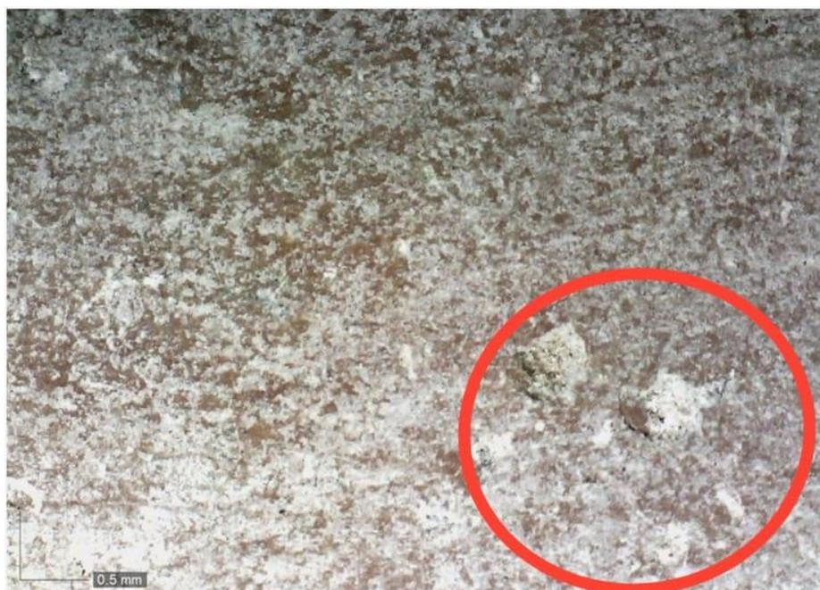
A micrografia ótica mostra região com aderência do material de acondicionamento à peça (em toda a área da imagem) e pontos de abrasão (indicados pelo círculo vermelho).
