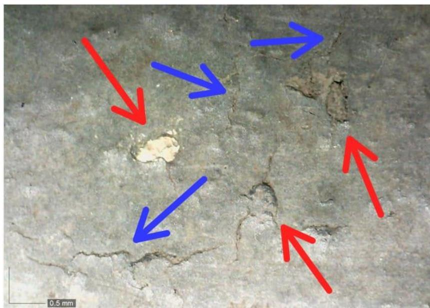
A micrografia ótica mostra região com pontos de abrasão (indicados pelas setas vermelhas) e fissuras (indicadas pelas setas azuis).
