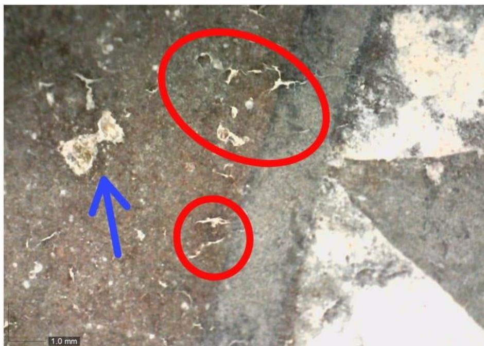
A micrografia ótica mostra região pintada contendo ponto de abrasão (indicado pela seta azul) e craquelamento da pintura (indicado pelas elipses vermelhas).
