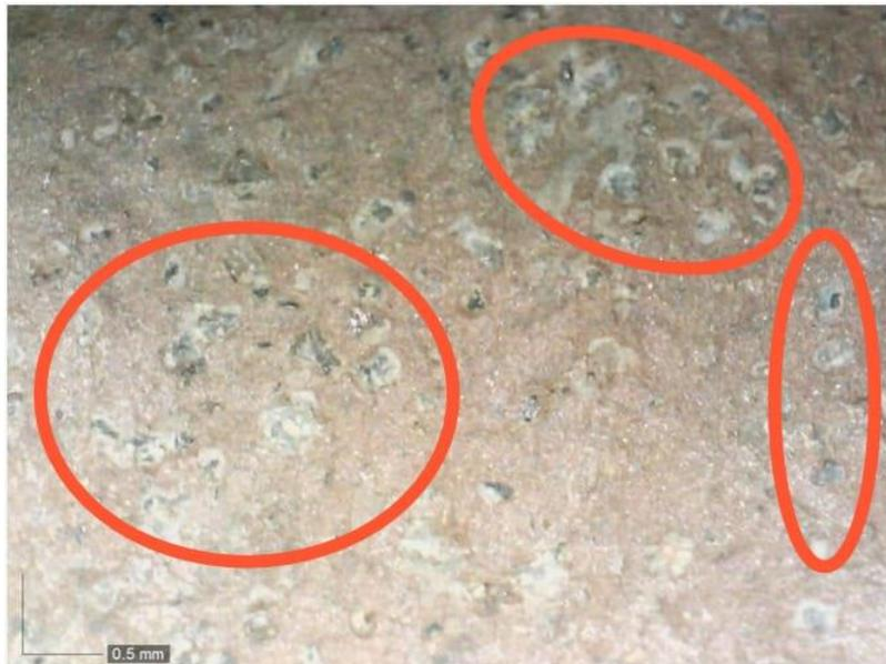
A micrografia ótica mostra região porosa da peça com alteração cromática e marcas de abrasão (indicadas pelas elipses vermelhas).
