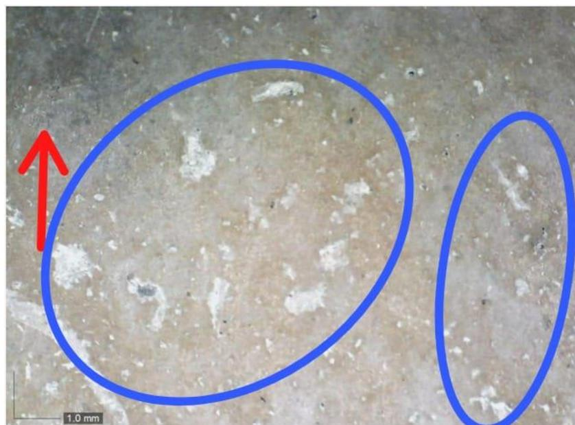
A micrografia ótica mostra região escurecida por marcas de queima (indicada pela seta vermelha) com pontos de abrasão (indicados pelas elipses azuis).
