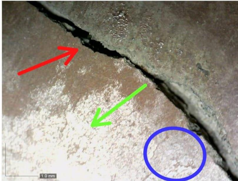
A micrografia ótica mostra rachadura (indicada pela seta vermelha), ranhuras (indicada pelo círculo azul) e manchas (indicada pela seta verde).
