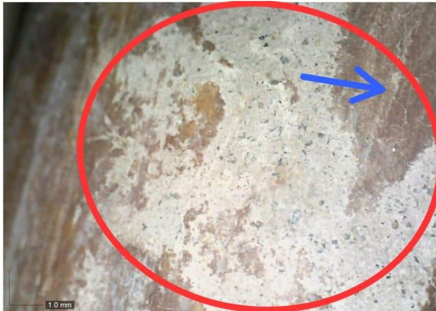
A micrografia ótica mostra local com marca de abrasão (toda a área indicada pela elipse vermelha) e ranhuras (indicadas pela seta azul).
