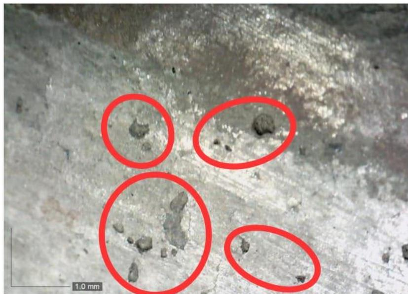
A micrografia ótica mostra região com marca de queima (em toda a área da imagem) e pontos de abrasão (indicados pelas elipses vermelhas).
