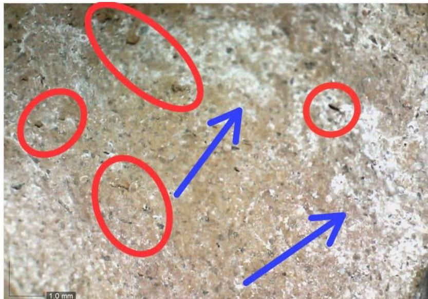
A micrografia ótica mostra região com aderência de material de embalagem à peça (indicada pelas setas azuis) e pontos de abrasão (indicados pelas elipses vermelhas).
