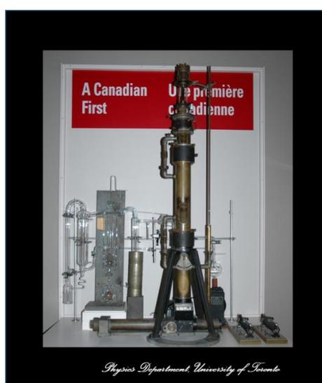
**Figura 05** – Microscópio eletrônico de transmissão concluído em 1938 por Prebus e Hillier – o primeiro do gênero na América do Norte.<sup>7</sup>
