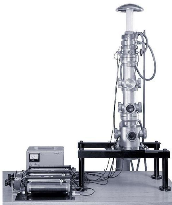
**Figura 03** – Réplica feita por Ruska do segundo microscópio eletrônico desenvolvido por ele e Knoll em 1933. Acervo Deutsches Museum.<sup>5</sup>
