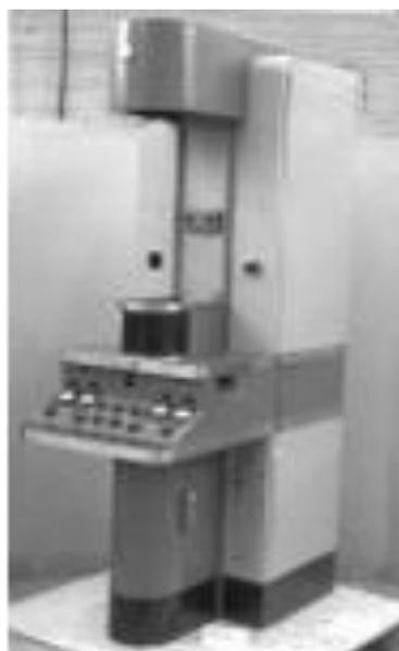
**Figura 28** – Microscópio eletrônico de transmissão RCA EMU-2B. Acervo Ingenium – Canada's Museum of Science and Innovation.<sup>18</sup>
