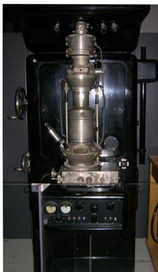
**Figura 04** – O primeiro microscópio eletrônico produzido em série pela Siemens, em 1939, desenvolvido por Ernst Ruska e Bodo von Borries. Acervo Deutsches Museum.<sup>6</sup>
