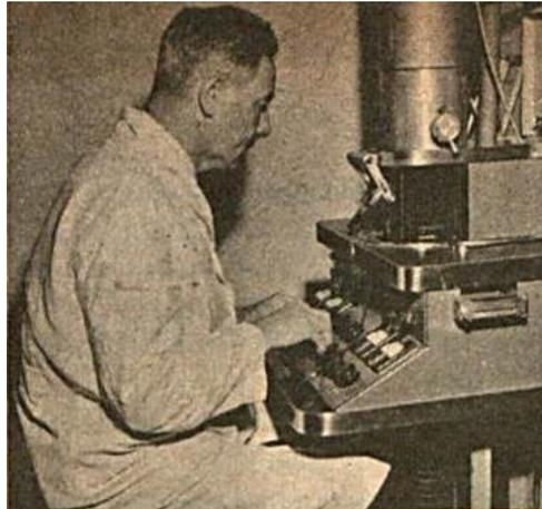
**Figura 42** – Hans Muth utilizando o microscópio eletrônico de transmissão RCA EMU 2C no Instituto Oswaldo Cruz (BONIS, 1956, p. 24).
