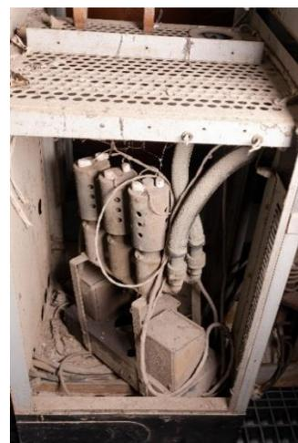
Exemplos de sujidades presentes atualmente, tanto na superfície externa quanto na parte interna do microscópio.
