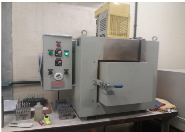
Figura 6 - Mufla para preparação do tubo para combustão
