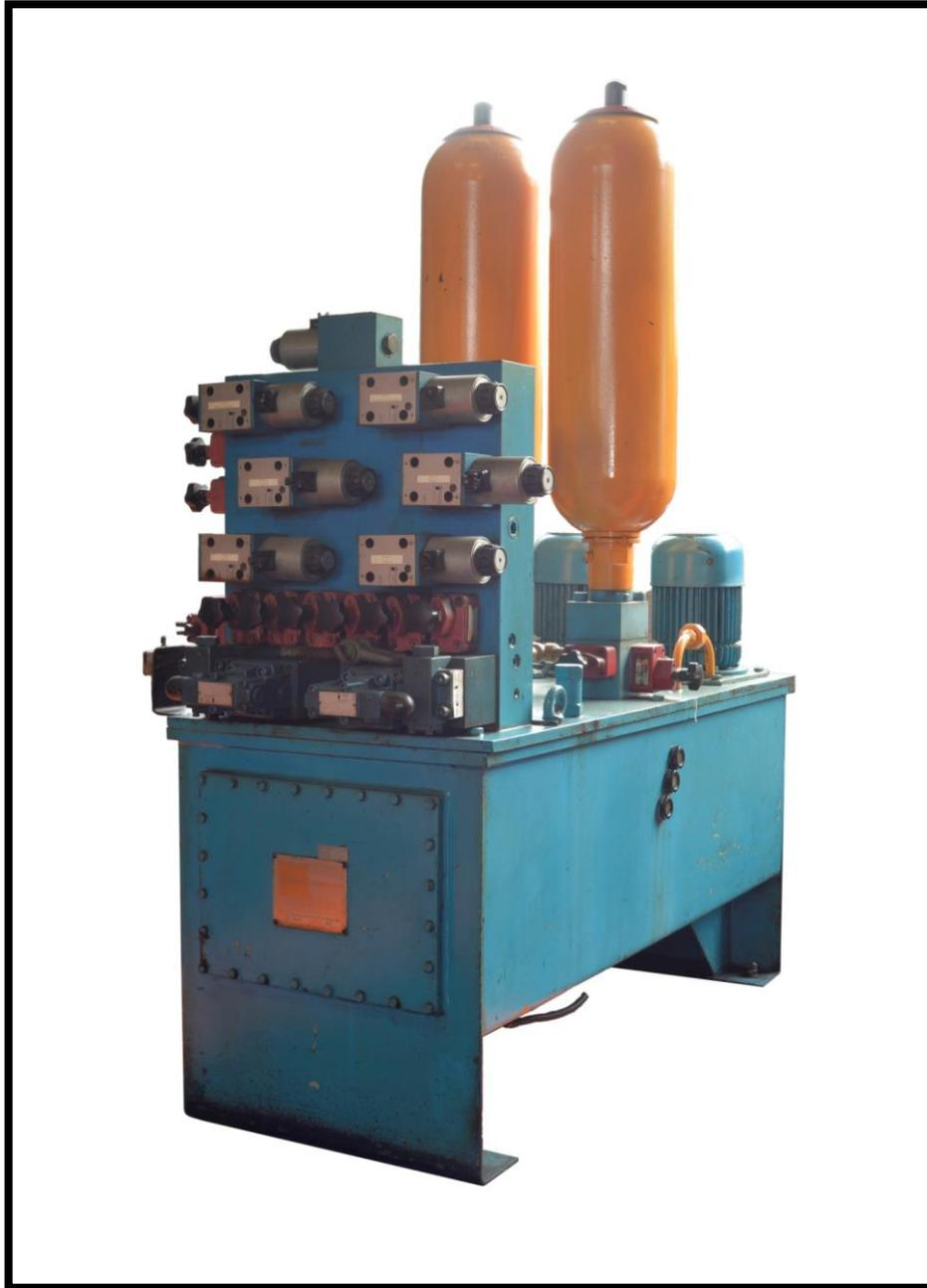
Figura 54. Central hidráulica de comando dos freios da estação motriz do teleférico de 1972, fabricada pela empresa Agudio, Itália, feita de aço, plástico e borracha, a sua função é liberar o óleo para erguer o freio de serviço, liberando a polia motriz para movimentar o teleférico. Está exposta atualmente na Casa de Máquinas da Estação III, Morro da Urca. Número de registro: 2000161. FONTE: Acervo CCAPA.
