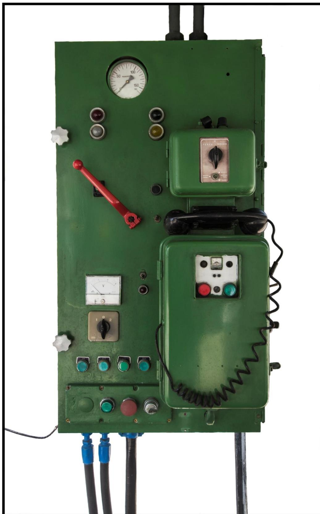
Figura 51. Painel de operações do Teleférico de 1972, fabricada pela empresa Agudio/Nardo, Itália, feita de aço e plástico e sua função era a comunicação dentro da cabine através do telefone, acionamento das portas entre outras operações. Está exposta atualmente na Praça dos Bondes, no Morro da Urca. Número de registro: 2000158. FONTE: Acervo CCAPA.
