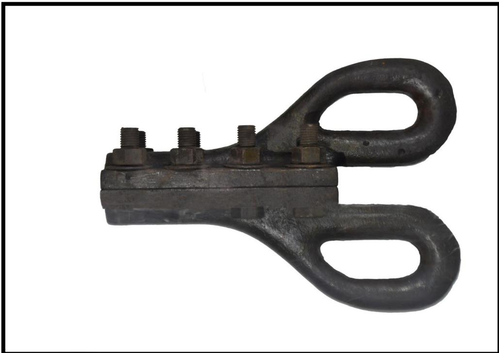
Figura 47. Morcete de manobra tipo cabeça de carneiro de 1912, fabricada pela empresa J.Pohlig Heckel, Alemanha, feito em aço e era utilizada para manobras envolvendo cabos. Está exposta atualmente no Espaço de Memória Cocuruto, Morro da Urca. Número de registro: 2000107. FONTE: Acervo CCAPA.
