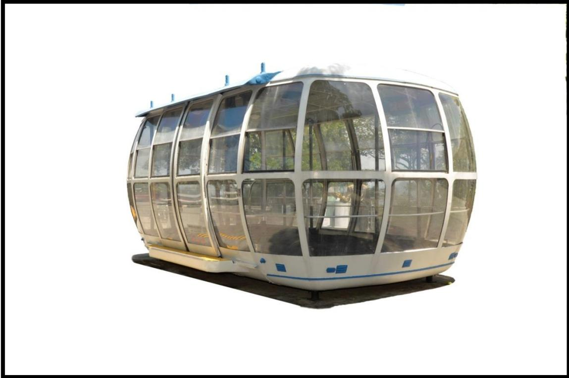
Figura 50. Cabine do Teleférico de 1972, fabricada pela empresa Agudio/Nardo, Itália. Produzida em ligas de alumínio, policarbonato e acrílico, com a função de transporte de passageiros. Está exposta atualmente na Praça dos Bondes, no Morro da Urca. Número de registro: 2000157. FONTE: Acervo CCAPA.
