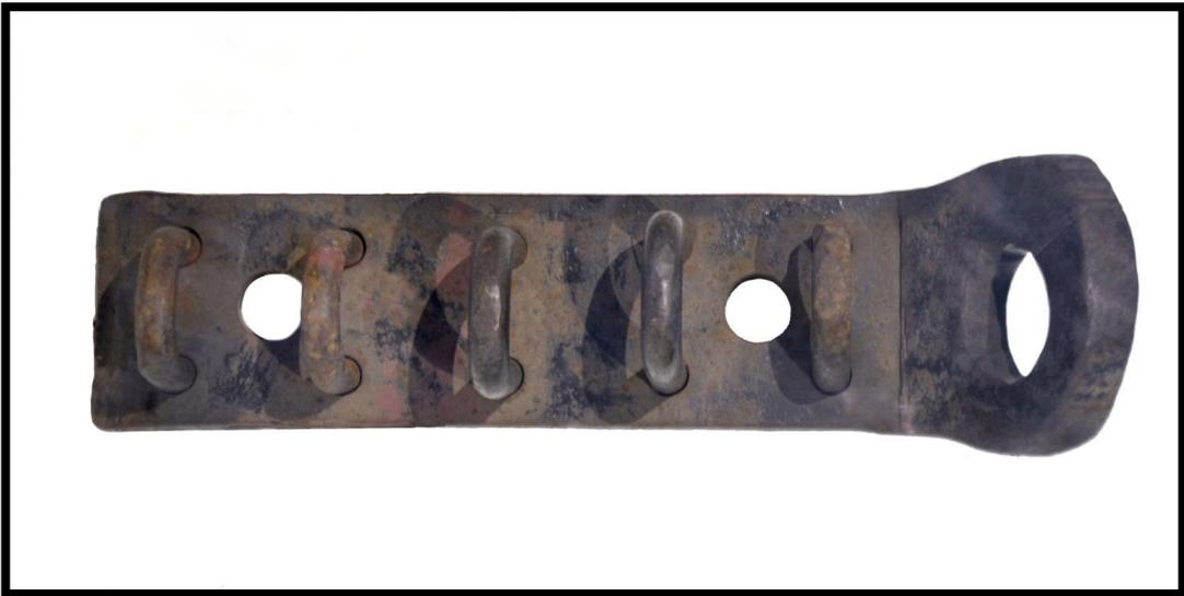
Figura 46. Morcete de manobra tipo Congolo-Mole, de 1912, fabricada pela empresa J.Pohlig Heckel, Alemanha, feito em aço. Era utilizada para manobras envolvendo cabos. Está exposta atualmente no Espaço de Memória Cocuruto, Morro da Urca. Número de registro: 2000150. FONTE: Acervo CCAPA.
