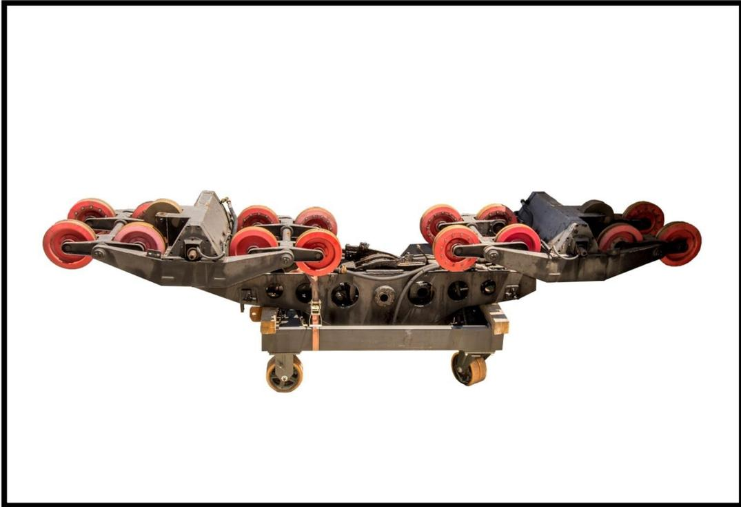
Figura 52. *Truck* do Teleférico de 1972, fabricada pela empresa Agudio, Itália. Feito de aço, plástico e poliuretano, sua função é deslizar sobre os cabos de sustentação e fixar o cabo de tração no teleférico. Está exposto atualmente no Mirante Forte do Leme, Morro da Urca. Ficou em operação até 2018, quando foi substituído. Número de registro: 2000159. FONTE: Acervo CCAPA..
