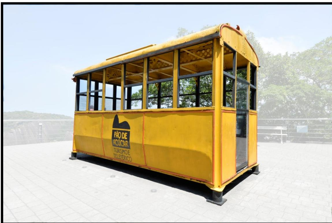
Figura 40. Cabine do Teleférico de 1912, fabricada pela empresa J.Pohlig. Hackel, feita em aço e madeira com função de transporte de passageiros. Está exposta atualmente na Praça dos Bondes, no Morro da Urca. Número de registro: 2000144. FONTE: FONTE: Acervo CCAPA
