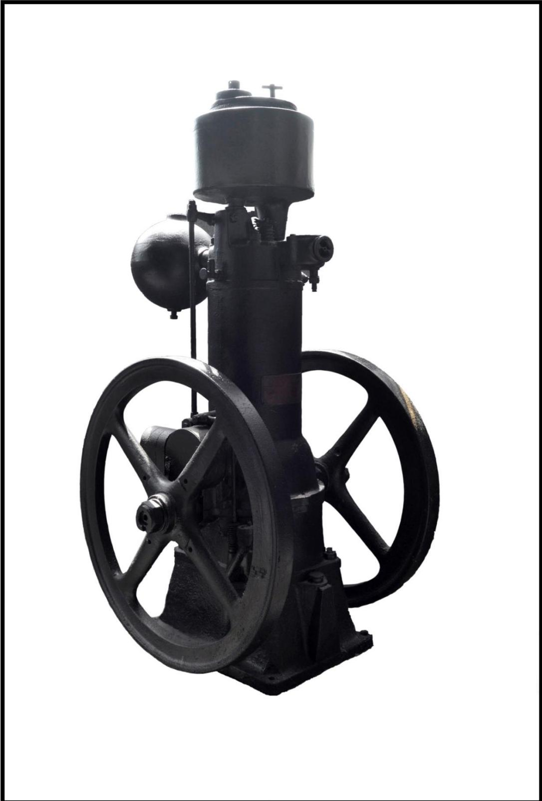
Figura 44. Motor a querosene de um pistão, de 1912, para uso em manobras. Fabricado pela empresa J.Pohlig. Hackel, feito em aço. Motor usado para diversas funções, como transporte de cargas e auxílio em manobras. Está exposto atualmente no Espaço de Memória Cocuruto, no Morro da Urca. Número de registro: 2000148. FONTE: Acervo CCAPA.
