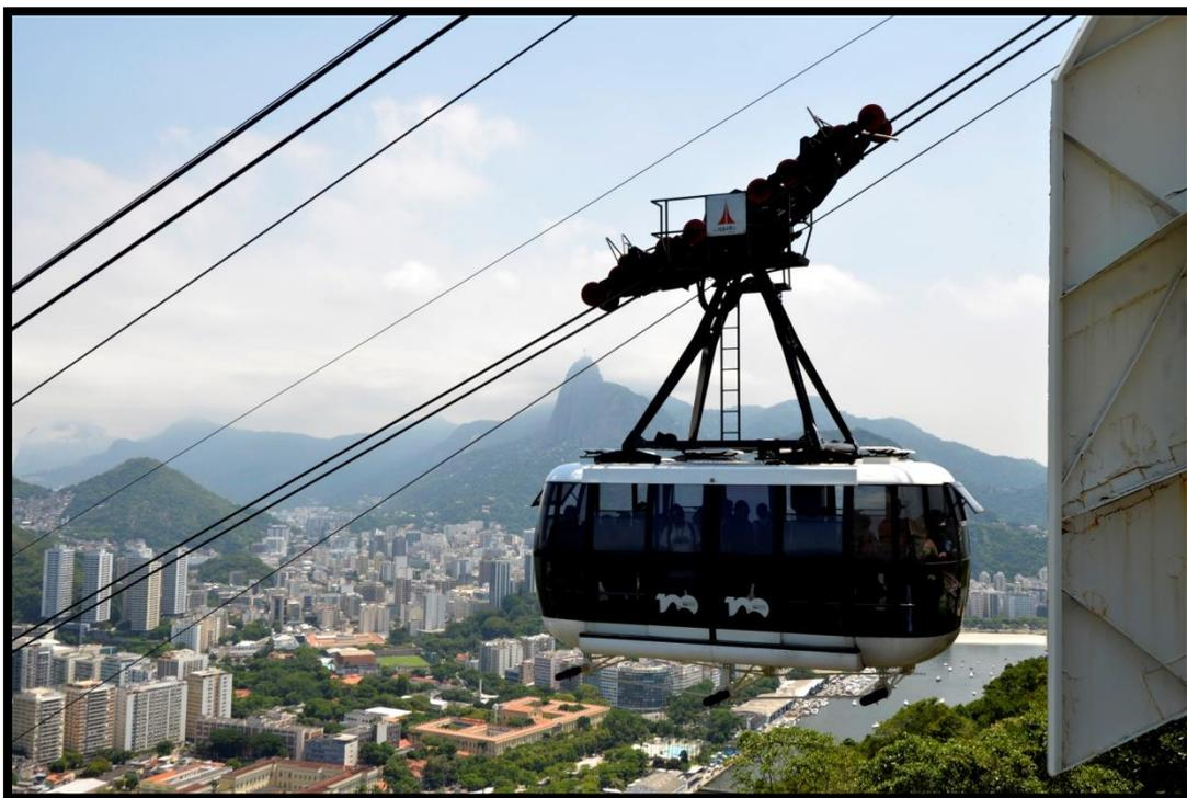
Figura 56. Cabine do Teleférico, de 2008, fabricada pela empresa CWA, Itália. Feita em ligas de alumínio, policarbonato e acrílico, com função de transporte de passageiros. Atualmente em pleno funcionamento.
