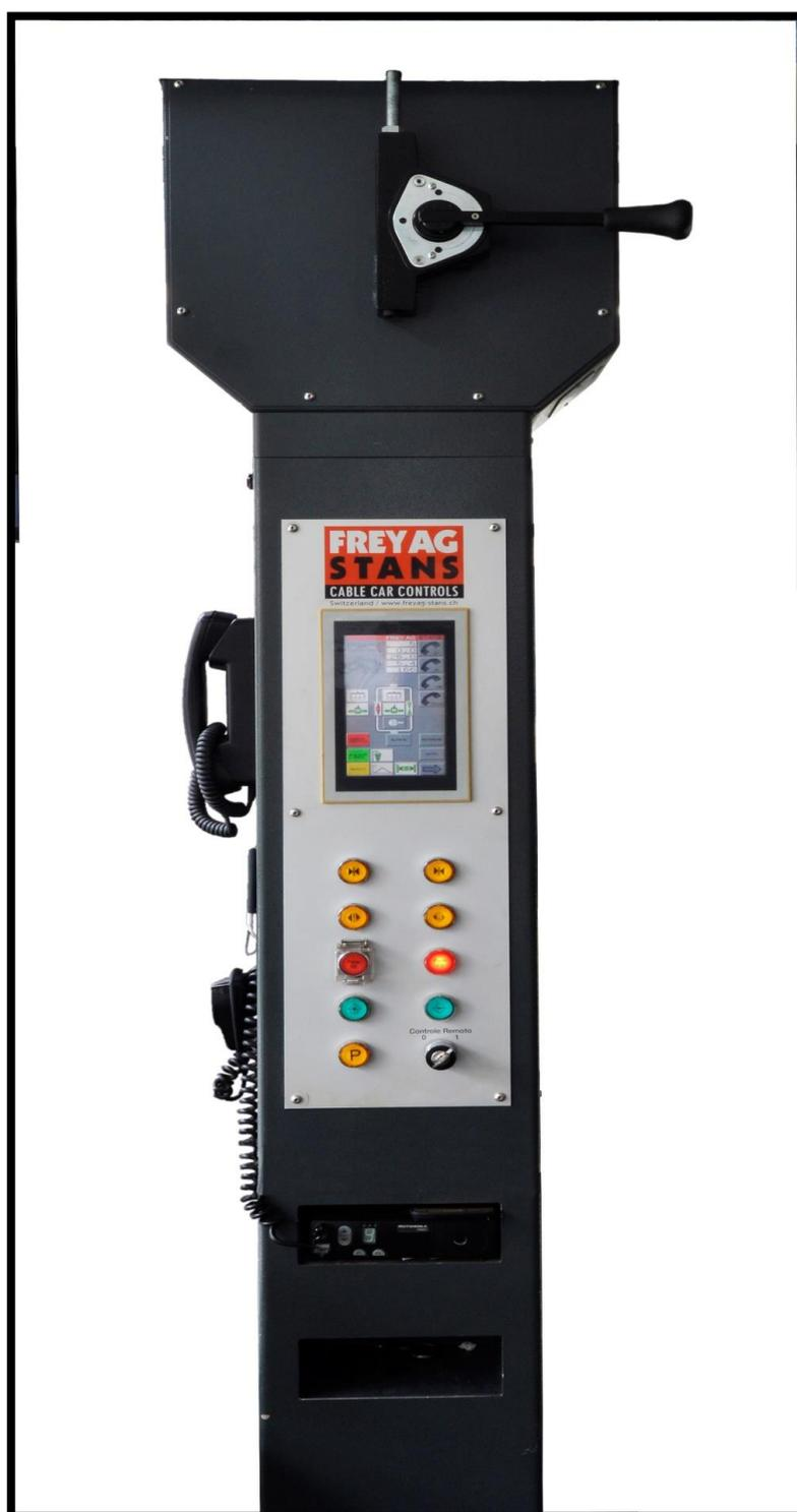
Figura 58. Painel de operações do teleférico da 3ª geração, 2008, fabricada pela empresa CWA, Suíça, produzido em aço, plástico e poliuretano. Pelo seu sistema de bobinas que realizam a comunicação, os parâmetros de segurança e operação do teleférico são transmitidos para a cabine e o painel os exibe para que o operador possa acionar o Bondinho, entre diversas outras funções, como abertura de portas etc. Foto Paulinho Muniz. Número de registro: 2000172 Fonte: Acervo CCAPA
