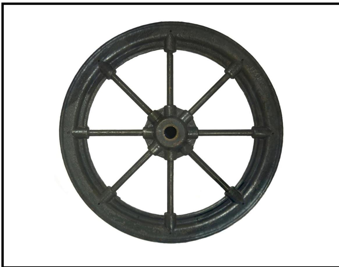
Figura 45. Polia de desvio do cabo de tensionamento, de 1912, fabricada pela empresa J.Pohlig Heckel, Alemanha, feito em aço com a função de desviar o cabo de tensionamento do contrapeso do teleférico de 1912. Está exposta atualmente no Espaço de Memória Cocuruto, Morro da Urca. Número de registro: 2000105.
