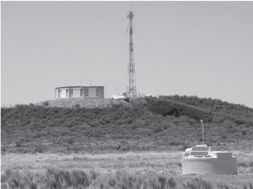
**Figura 12.** Ao fundo, um dos prédios que abriga seis telescópios de fluorescência. Em primeiro plano, um dos 1.660 detectores de superfície (Acervo Observatório Pierre Auger)
