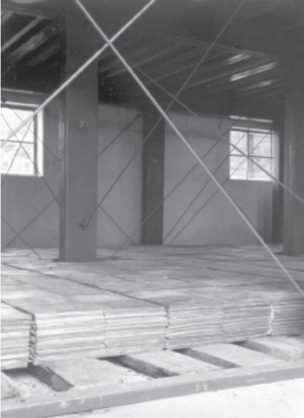
**Figura 8.** A câmara inferior já montada, com os envelopes contendo filmes e emulsões nucleares intercalados com placas de chumbo. Vê-se também a estrutura metálica que suporta a câmara superior, com montagem similar (Acervo DRCC<sup>28</sup>/IFGW)
