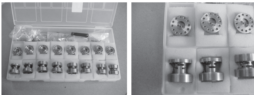
Figura 11. À esquerda: conjunto de oito transdutores do sexto e último modelo testado. O corpo dos transdutores é de nióbio muito puro (pureza da ordem de 99,99%). Uma das suas metades fica firmemente presa ao orifício da esfera , quando ela se resfria até temperaturas criogênicas. A outra metade pode, então, oscilar na frequência de 3,2 kHz, a mesma da esfera , por causa da "mola" na parte central, vista no detalhe da Figura à direita.
