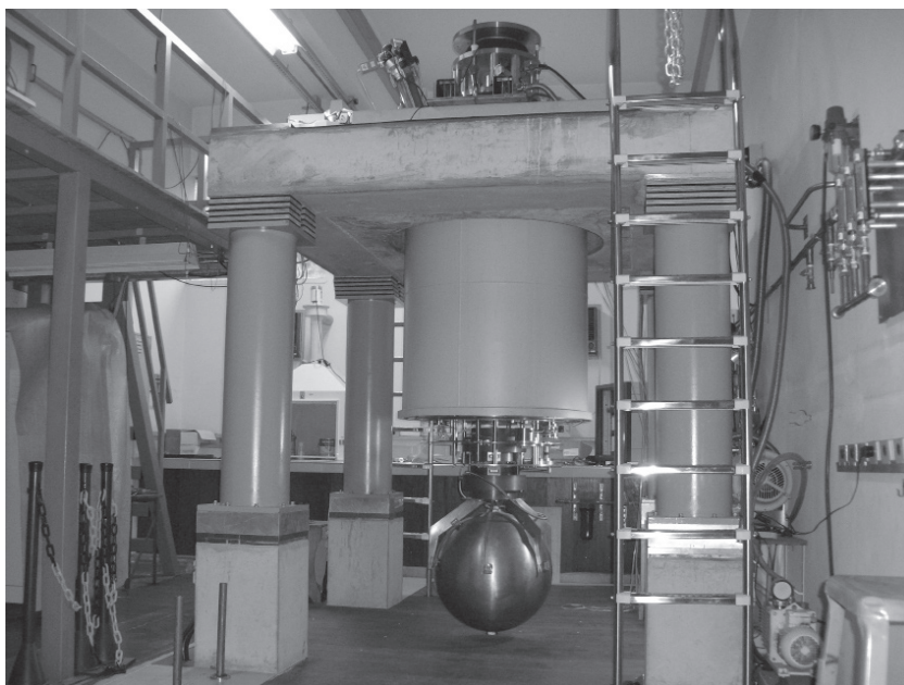
Figura 10. Visão mais recente do detector Schenberg, já com a plataforma de concreto imobilizada para proteção dos transdutores , em altura adequada para o fechamento da câmara criogênica por baixo (pois o assoalho é removível) e introdução da linha de transferência por cima. O sistema de aquisição e processamento dos dados fica no mezanino à esquerda. O 1K pot do refrigerador por diluição já se encontra instalado
