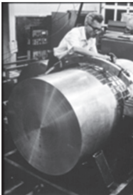
Figura 1. Joseph Weber junto a uma das suas antenas ( barra ) de ondas gravitacionais (Cortesia do grupo da antena Allegro da Universidade Estadual da Louisiana, LSU)
