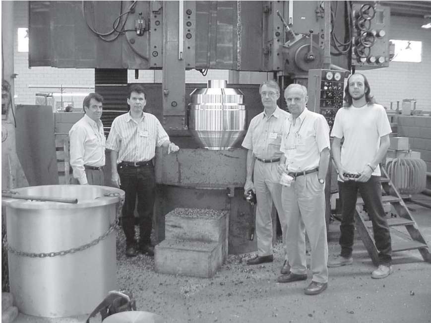
Figura 4. A primeira esfera , que foi para o Mini-GRAIL em Leiden, sendo usinada na Italbronz e em Arujá, SP, no km 106 da rodovia Dutra, e era a segunda esfera fundida pela companhia. A primeira (Figura 4) havia sido enviada para o grupo de Leiden. Esse grupo também ficou com a terceira, que foi fundida com diâmetro um pouco maior, 68 cm, em vez dos 65 cm das duas anteriores. Foto tirada com câmera do Projeto do Detector Mário Schenberg
