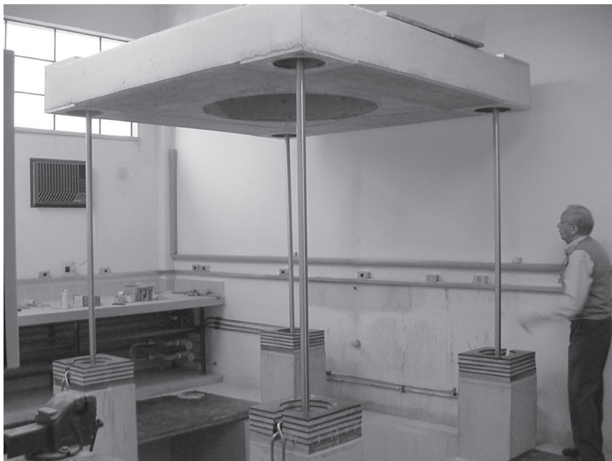
Figura 3. O professor Nei realizando teste no sistema hidráulico da plataforma de concreto em 2001. Foto tirada com câmera do Projeto do Detector Mário Schenberg
