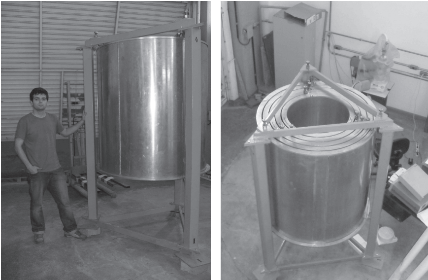
Figura 12. À direita: sistema de isolamento vibracional formado por pêndulos multi-aninhados, que estão sendo desenvolvidos no LOG do INPE para utilização nas versões futuras do LIGO. Márcio Constânciao Jr., um dos alunos envolvidos neste trabalho, pode ser visto à esquerda para referência de tamanho
