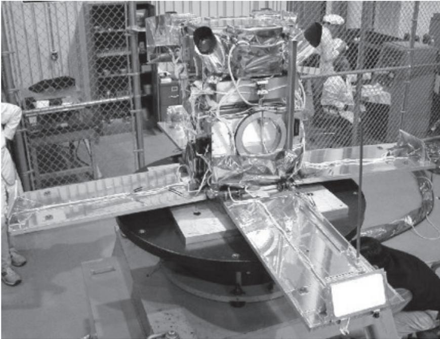
**Figura 7.** O satélite HETE-2 em preparação para lançamento por um foguete *Pegasus*. Este satélite contou com a colaboração científica do INPE e com uma estação de recepção em Natal, RN. As dimensões do satélite, excluindo os painéis solares, são de aproximadamente 2 m x 1 m x 1 m (Fonte: NASA)
