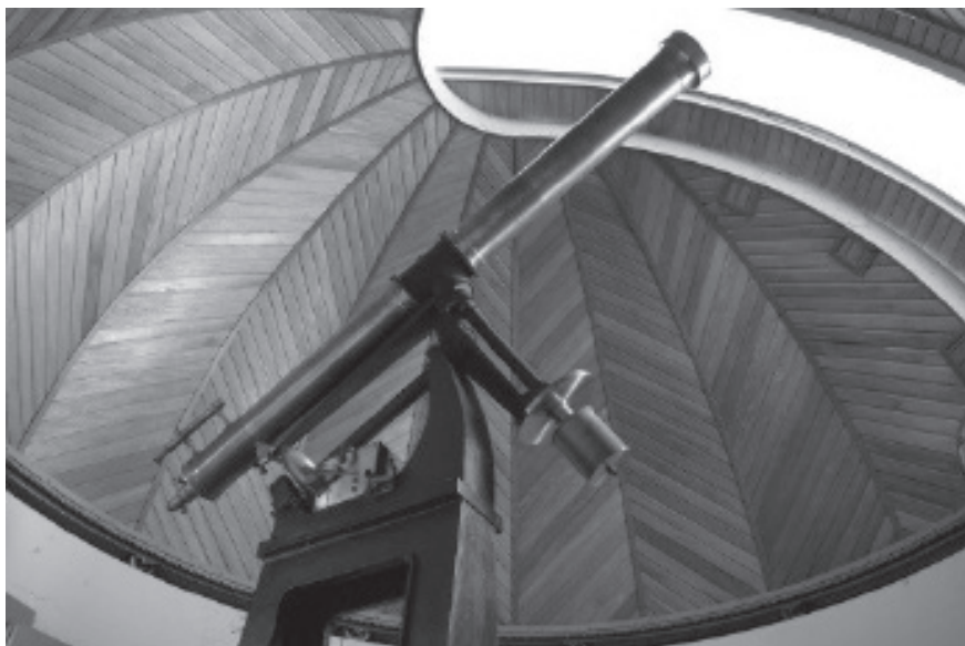
Figura 3. Luneta equatorial Gautier de 190 mm (diâmetro da objetiva), razão focal 4 15, fabricada em 1907, na cúpula restaurada em 2002 e ainda utilizada nas observações públicas. Foto do autor
