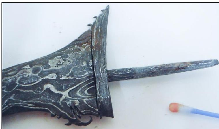
**Figura 8** – Teste de dimetilglioxima realizado na adaga *kris* de lâmina sinuosa, apresentando uma tonalidade rosa acastanhado, o que indica possível presença de Ni.
