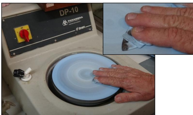
**Figura 6** – O polimento da ponta da flecha foi realizado por uma poltriz semiautomática da marca *Struers*, modelo *DP-10*, no LABET, do MN/UFRJ.
