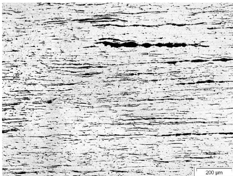
Figura 6 - A superfície polida da amostra PMT-84 (dobradiça) mostra a presença de grande quantidade de inclusões não-metálicas, que são as partes pretas dessa foto. O fundo branco é a parte metálica, o ferro da dobradiça. Essa microestrutura é típica de materiais do início do século XIX. A fração volumétrica de inclusões foi estimada em 7% (MAIA, 2014)
