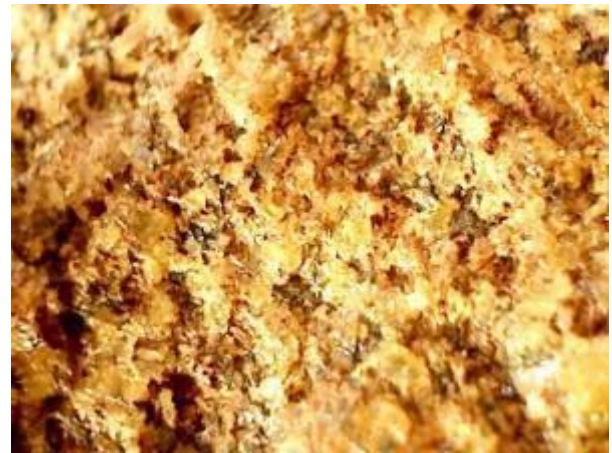
Figuras 05 e 06 - Imagens microscópicas da composição mineralógica do granito presente no sítio, e as diferenças cromáticas resultantes dos efeitos de oxidação de partes das rochas emersas. Fonte: Maria Conceição Soares Meneses Lage ( in situ ), 2015
