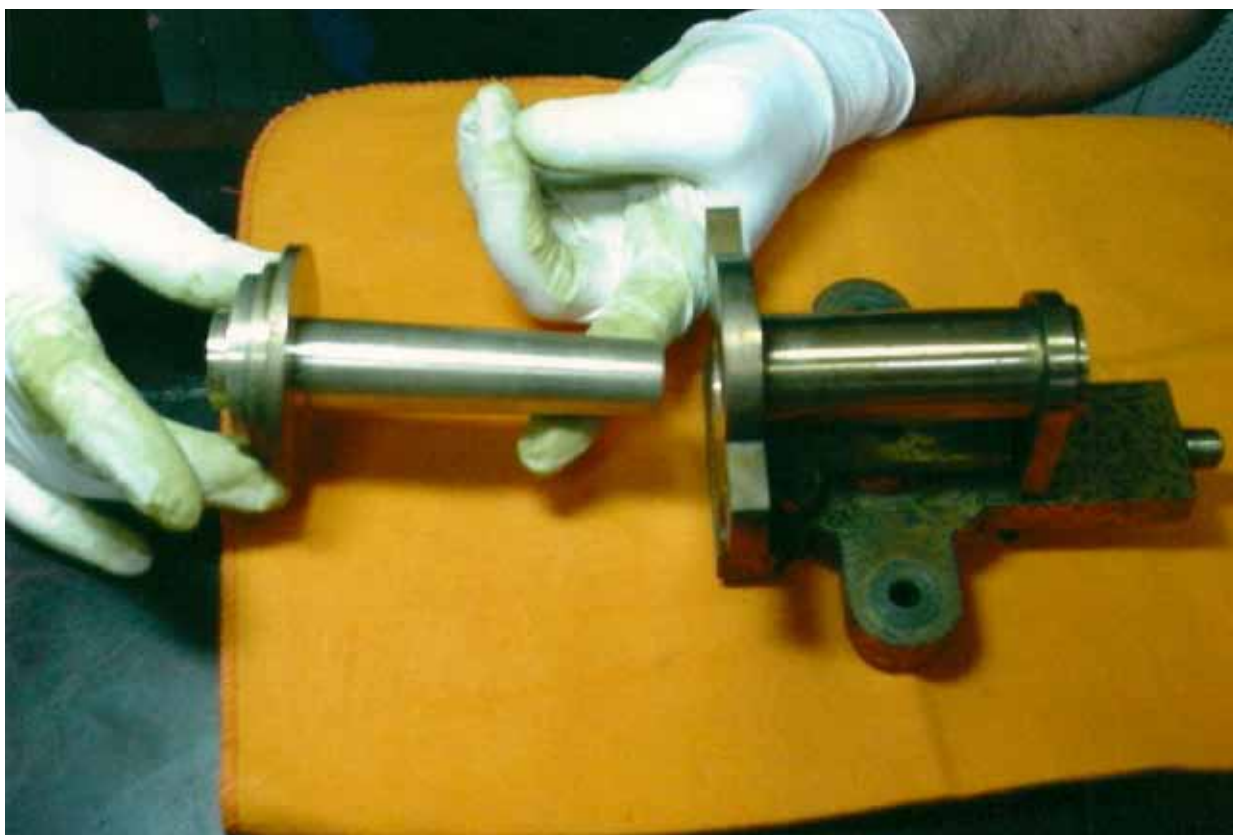
Figura 4 – Imagem de uma das etapas da desmontagem do instrumento, mais especificamente das peças do eixo do círculo vertical. Fotografia de Marcus Granato, 2002. Acervo MAST, Rio de Janeiro.
