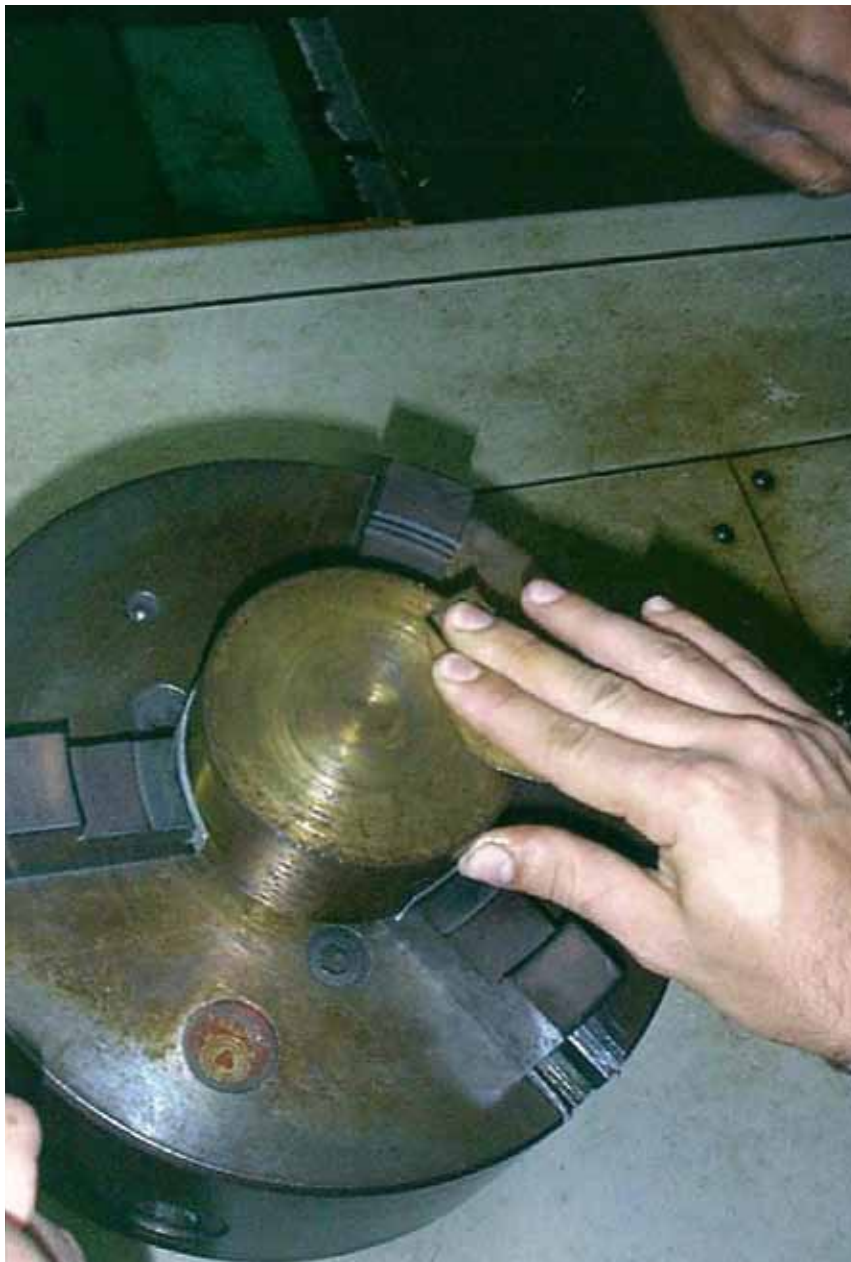
Figura 8 – Contrapeso do teodolito fixado ao torno, para trabalhos de restauro da peça. Fotografia de Marcus Granato, 2003. Acervo MAST, Rio de Janeiro.
