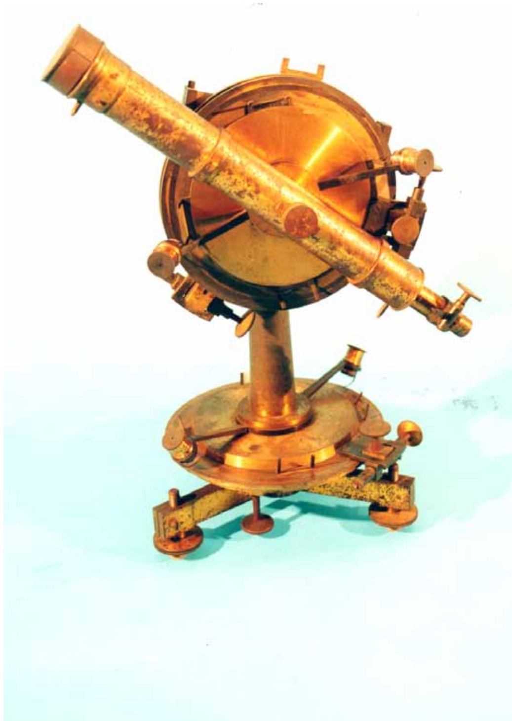
Figura 1 – Teodolito astronômico utilizado no estudo. Fotografia de Ricardo de Oliveira Dias, 2002. Acervo MAST, Rio de Janeiro.
