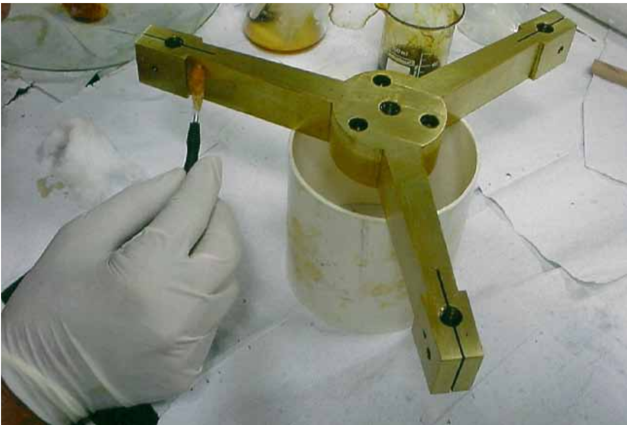
Figura 10 – Imagens do envernizamento do tripé de sustentação do instrumento (a) e da cura da coluna central, na estufa (b), após envernizamento. Fotografia de Ricardo de Oliveira Dias, 2003. Acervo MAST, Rio de Janeiro.
