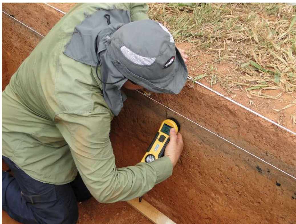
Figura 12 - Perfil de solo no geoglifo JK ilustrando a ausência de horizonte escuro na superfície e a presença de um horizonte levemente escurecido enterrado, provavelmente por processos erosivos. Foto: Wenceslau Teixeira.
