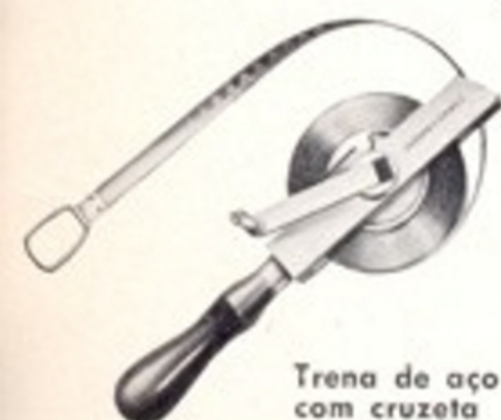
Metro de prova para controle de miras falantes
