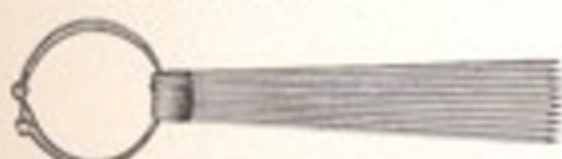
Pino de aço para marcação
