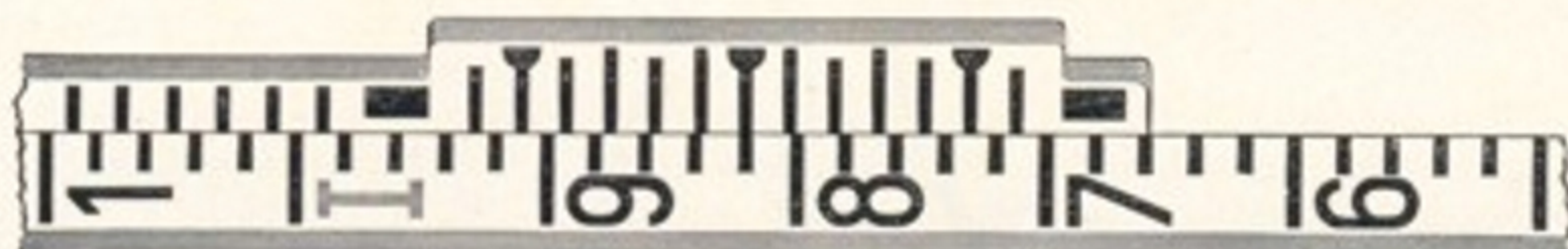
Neue Querlatte mit 2 cm-Teilung. Ablesung 73,00 + cm + m/m der Meßtrommel.
